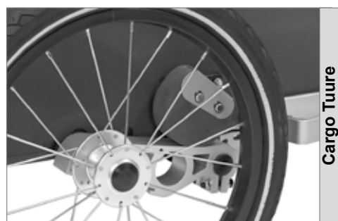
Wartungsfreie AirPad®-Federung mit Sylomer® (Cargo Tuure)
