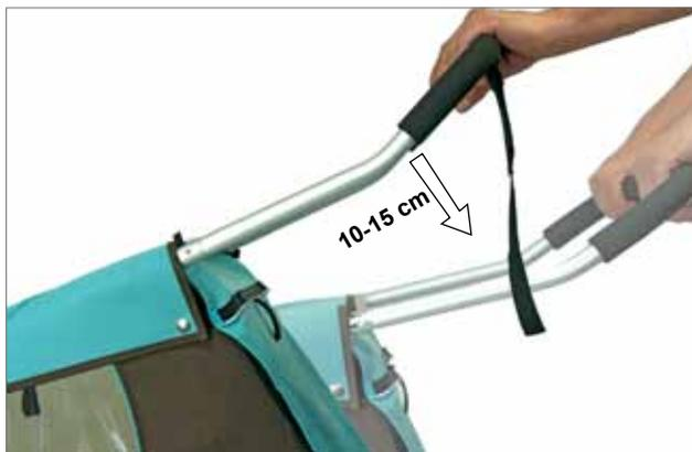
**Tipp:** Solltest du nicht sicher sein, ob der Croozer Kid Plus richtig beladen ist, kannst du diesen Test durchführen: Drücke den Schiebebügel des beladenen Croozer Kid Plus ohne Kind ca. 10–15 cm nach unten, so dass das Buggyrad vom Boden abhebt.
