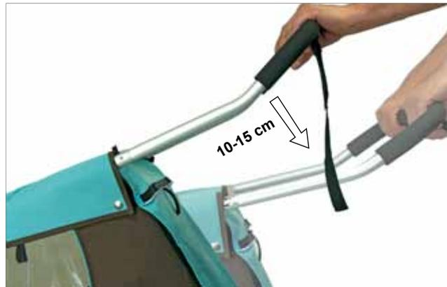
**Tipp:** Solltest du nicht sicher sein, ob der Croozer Kid Plus richtig beladen ist, kannst du diesen Test durchführen: Drücke den Schiebebügel des beladenen Croozer Kid Plus ca. 10–15 cm nach unten, so dass das Walkerrad vom Boden abhebt.
