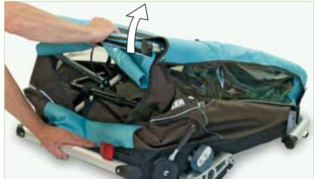
4. Halte das obere Rohr fest und ziehe den Sitzrahmen langsam und vorsichtig nach hinten, bis die Sperrbolzen (4) beider Aufbauverriegelungen (3) hörbar in den Bohrungen (5) der Rahmenrohre einrasten.
