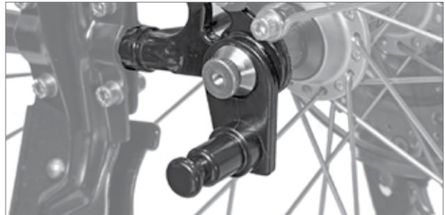
Sollte sich der Schnellspanner verdrehen lassen, ist die Klemmkraft nicht ausreichend. Öffne den Klemmhebel und schraube die Achsmutter um eine halbe Umdrehung im Uhrzeigersinn. Wiederhole die Schritte 5 und 6.
