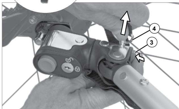
3. Führe das Sicherungsfangband (5) um das Rahmenrohr und stecke den Stift (4) zurück in die Bohrung, bis er hörbar einrastet. Ziehe leicht daran, um dich zu vergewissern, dass der Stift eingerastet ist. Achte darauf, dass sich das Sicherungsfangband (5) nicht in den Speichen oder Scheibenbremsen verfangen kann.
