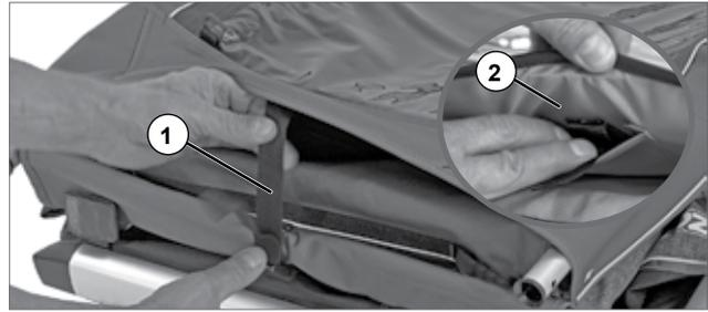
3. Halte den Rahmen des Croozer mit einer Hand fest und ziehe mit der anderen den Aufbau nach oben.
