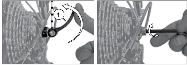
6. Prüfe, ob der Schnellspanner wirklich fest geschlossen ist, indem du versuchst, den geschlossenen Schnellspanner um die eigene Achse zu verdrehen.
