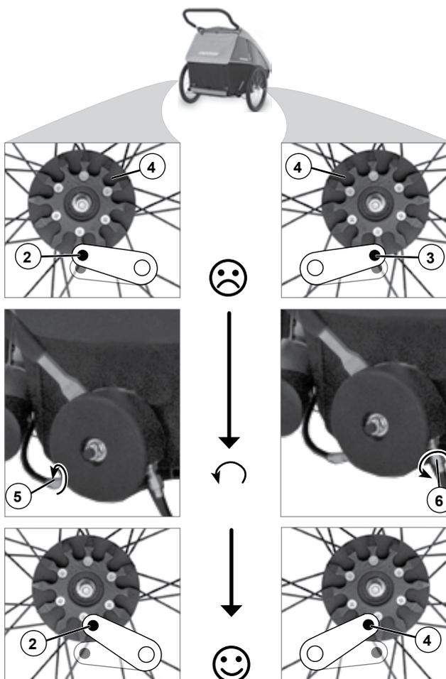
3. Greift der Bremszapfen (2) auf der linken Seite des Croozer nicht vollständig in die Rastscheibe (4), dann drehe die Einstellschraube (5) am Bremshebel so lange gegen den Uhrzeigersinn, bis der Bremszapfen (2) vollständig in die Rastscheibe (4) greift.
