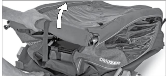
4. Halte das obere Rahmenrohr fest und ziehe den Sitzrahmen langsam und vorsichtig nach hinten, bis die Sperrbolzen (4) beider Aufbauverriegelungen (3) hörbar in den Bohrungen (5) der Rahmenrohre einrasten.
