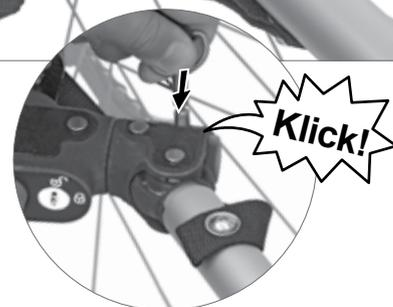
4. Um Diebstähle oder unbefugtes Abkuppeln des Croozer vom Zugfahrrad zu verhindern, ist der Deichselkopf mit einem Schloss ausgestattet. Der Croozer lässt sich somit fest an das Zugfahrrad anschließen.
