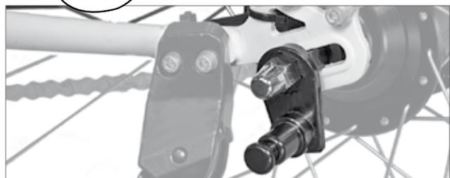
**Tipp:** Sollte kein Platz für die Montage der Achskupplung vorhanden sein oder sollte das Gewinde der Vollachse zu kurz sein, dann kannst du die als Zubehör erhältliche Click & Crooz® Achsmutterkupplung verwenden, die die vorhandene Achsmutter ersetzt.
