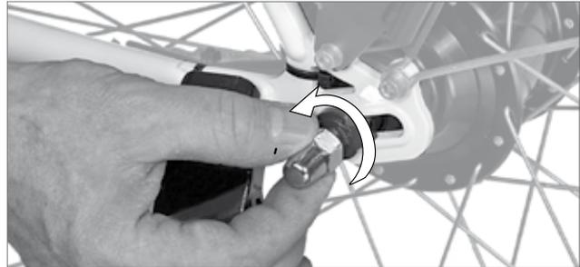
2. Setze die Achskupplung (3) auf die Achse, ohne die Sicherungsscheibe zu entfernen.
