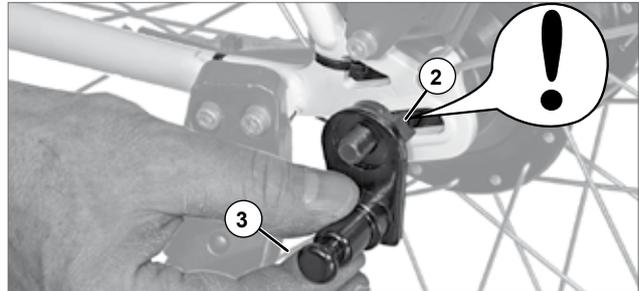
3. Schraube die Achsmutter (1) mit mindestens fünf vollen Drehungen auf das Gewinde der Vollachse.
