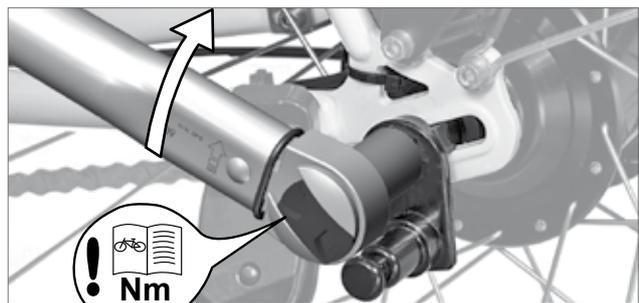
5. Versuche zum Schluss, das Hinterrad in den Ausfallenden zu bewegen, um sicherzugehen, dass es korrekt befestigt ist.
