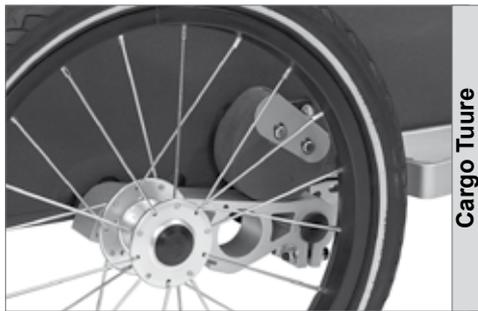
Wartungsfreie AirPad® -Federung mit Sylomer® (Cargo Tuure)
