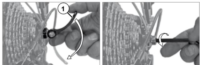
2. Schraube die Achsmutter (2) des Schnellspanners gegen den Uhrzeigersinn heraus. Vorsicht, darunter befindet sich eine kleine Feder, die wegspringen könnte.
