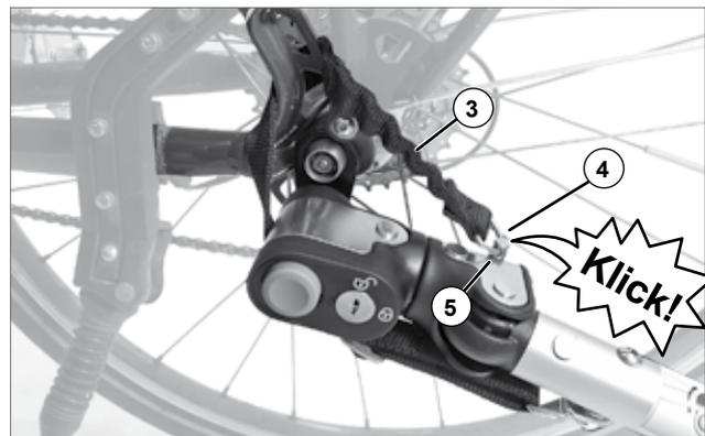
**Tipp:** Die Länge des Sicherungsfangbandes lässt sich einstellen. Das Sicherungsfangband muss möglichst kurz eingestellt sein, damit es nicht mit Speichen, Nabe oder Scheibenbremse in Kontakt kommen kann. Überprüfe die Länge des Sicherungsfangbandes, wenn du die Deichsel an einem anderen Fahrrad verwendest.
