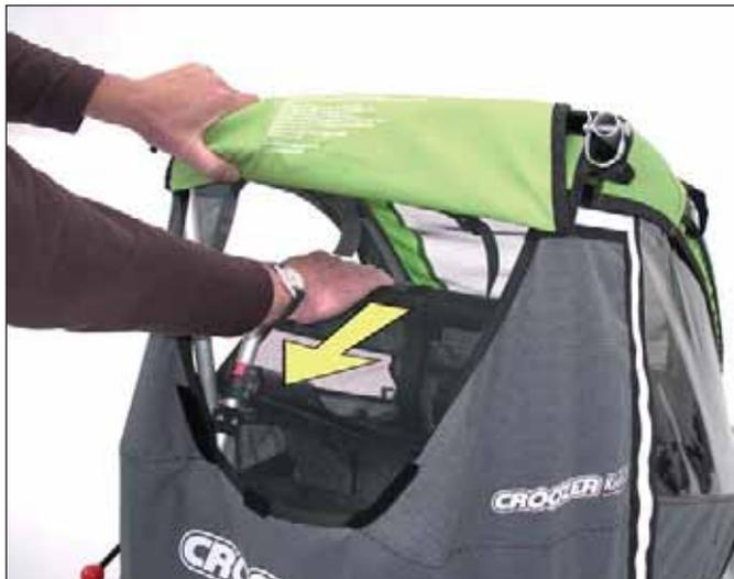
Schließen Sie zunächst die in Fahrtrichtung linke Aufbauverriegelung. Die linke Aufbauverriegelung ist korrekt geschlossen, wenn das rote Rastelement über das nach oben weisende Rahmenrohr geschnappt wurde.
