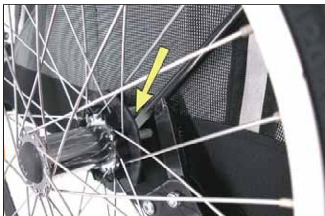
Zum Lösen drücken Sie den Bremshebel bis zum Anschlag nach unten.
