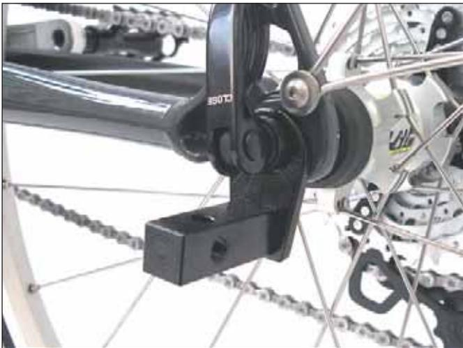
Der Schnellspanner ist dann richtig eingestellt, wenn gegen Ende des Schließvorgangs ein deutlicher Widerstand spürbar ist. Dieser Widerstand sollte etwa 60° vor dem Ende der Hebelbewegung gefühlt werden. Lässt sich der Schnellspanner zu schwer oder zu leicht betätigen, wird die Einstellmutter auf der anderen Nabenseite etwas auf bzw. zu gedreht.
