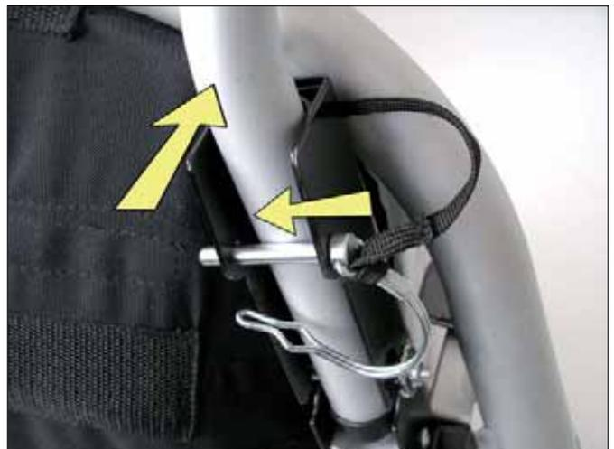
Sichern Sie den Sicherungsstift, in dem Sie den Sicherungsbügel über den Stift schnappen lassen.
