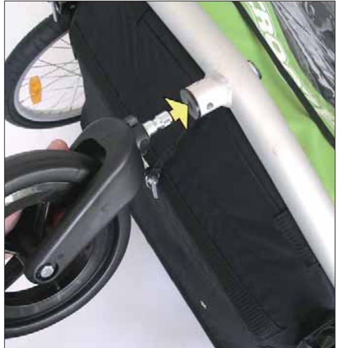
Stecken Sie den Sicherungsstift durch die Querbohrung der Hülse.
