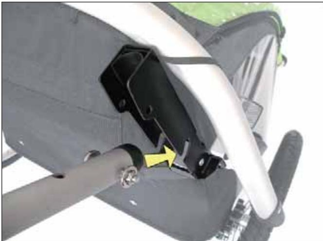
Die seitlichen Bolzen müssen in die Führungsschlitze der Deichselaufnahme eingreifen.
