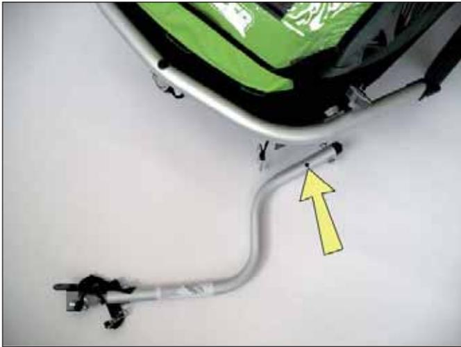
Drücken Sie die Deichsel nach oben, so dass die Bolzen in den Führungsschlitzen nach oben rutschen.
