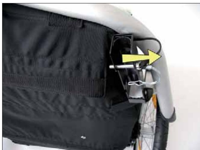
Die Deichsel wird so am Fahrzeug befestigt, dass die Bohrung an ihrem hinteren Ende nach oben weist.
