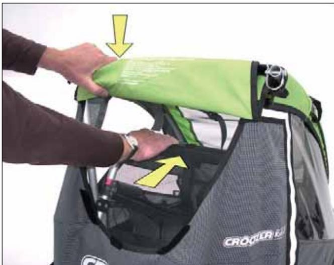
Ziehen Sie den Stoffaufbau dabei rechts und links nach außen. Sonst besteht die Gefahr, dass er zwischen den Rahmenrohren gequetscht und beschädigt wird.
