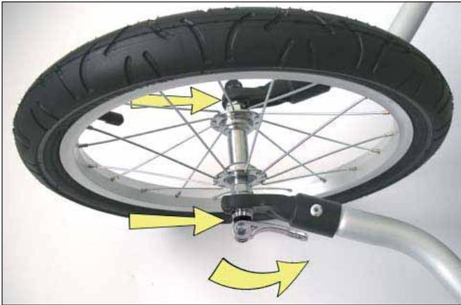
Falls sich das Joggerad nicht in die Ausfallenden schieben lässt, drehen Sie die Einstellmutter des Schnellspanners gegen den Uhrzeigersinn auf.
