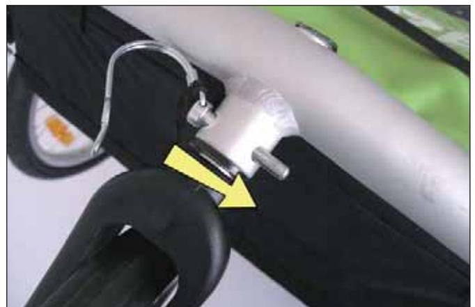
Sichern Sie den Sicherungsstift, in dem Sie den Sicherungsbügel über den Stift schnappen lassen.
