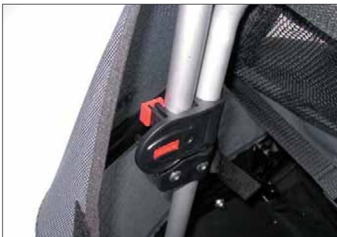
Schließen Sie nun die rechte Aufbauverriegelung: Ziehen Sie den roten Schiebeknopf nach hinten und drücken Sie gleichzeitig die Aufbauverriegelung nach außen.
