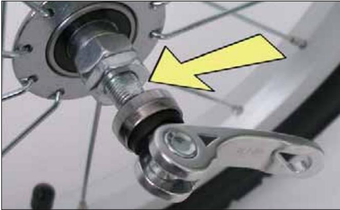
Öffnen Sie den Schnellspannhebel des Joggerades so weit wie möglich. Schieben Sie das Joggerad so in die Ausfallenden der Radausleger, dass die Abflachungen der Achse parallel zum Schlitz der Ausfallenden liegen.
