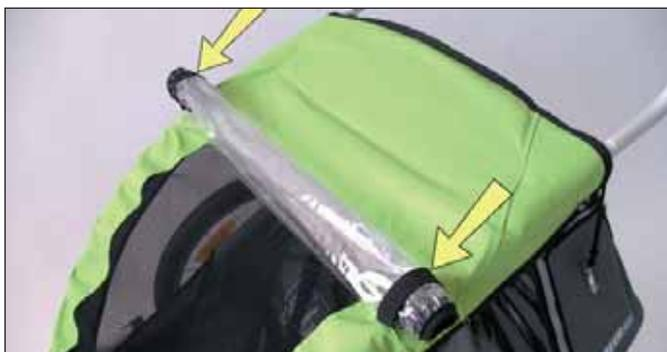
Das gesamte 2 in 1-Verdeck kann ebenfalls aufgerollt und mit einem zentralen Spannband fixiert werden. Dazu muss die Klarsichtscheibe nach unten ausgerollt und auf dem Stoffrahmen fixiert sein.
