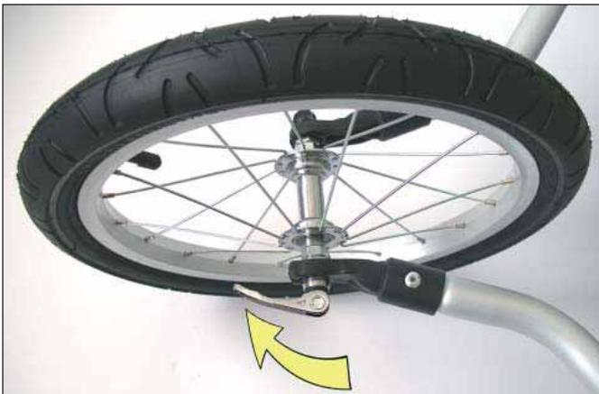
Der Schnellspanner ist dann richtig eingestellt, wenn gegen Ende des Schließvorgangs ein deutlicher Widerstand spürbar ist. Dieser Widerstand sollte etwa 60° vor der Endstellung des Schnellspannhebels spürbar sein.
