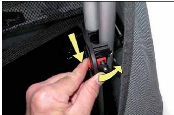
Lassen Sie den roten Schiebeknopf los. Der Sperrbolzen soll jetzt in die zugehörige Bohrung im nach oben weisenden Rahmenrohr einrasten. Ggf. müssen Sie dazu die Aufbauverriegelung bei losgelassenen Schiebeknopf etwas hin und her bewegen.
