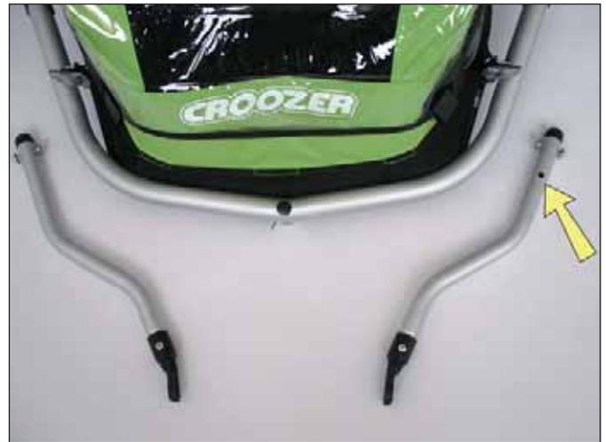
Das Montieren und Sichern der beiden Radausleger erfolgt in der selben Weise wie das Einsetzen der Deichsel (siehe Kapitel 5.5).
