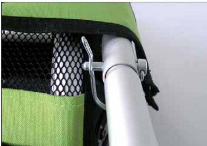
Ziehen Sie das hintere Ende des 2 in 1-Verdecks wieder zurück über den Sicherungsstift. Achten Sie darauf, ob die Druckknöpfe, mit denen das 2 in 1-Verdeck befestigt wird, geschlossen sind (siehe Kapitel 4.4).
