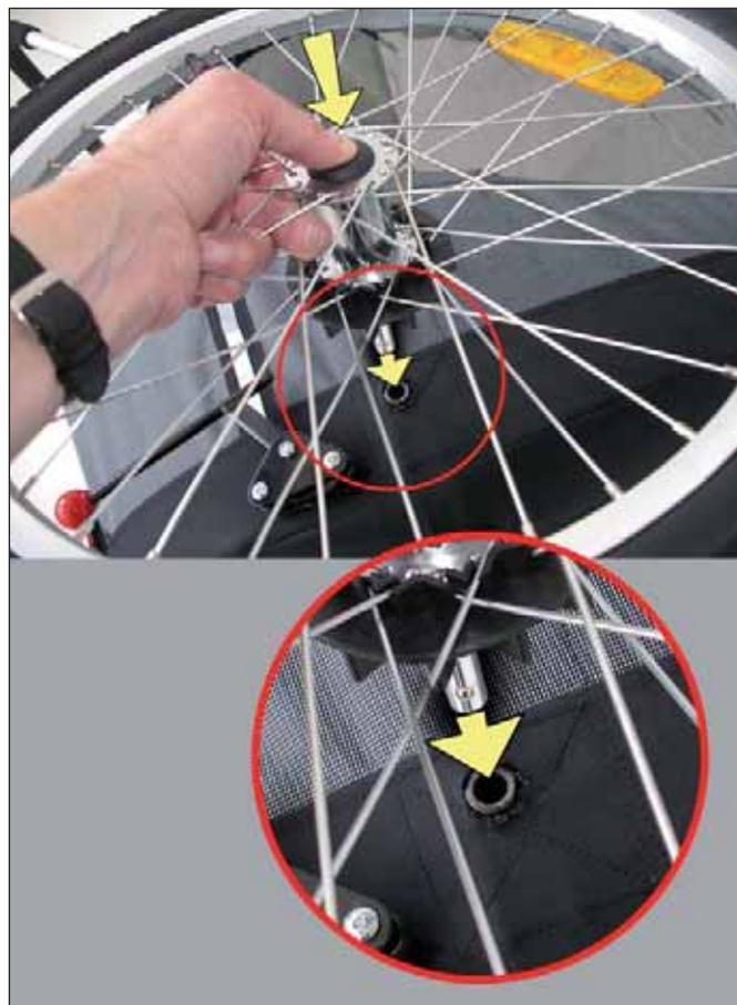
Achten Sie immer darauf, dass die Achsaufnahme frei liegt. Der Stoff darf nicht über die ringförmige seitliche Fläche der Achsaufnahme ragen. Sonst kann die Radachse nicht weit genug in die Achsaufnahme gesteckt werden, was zur Folge hat, dass die Sperrkugeln nicht vollständig verriegeln können.
