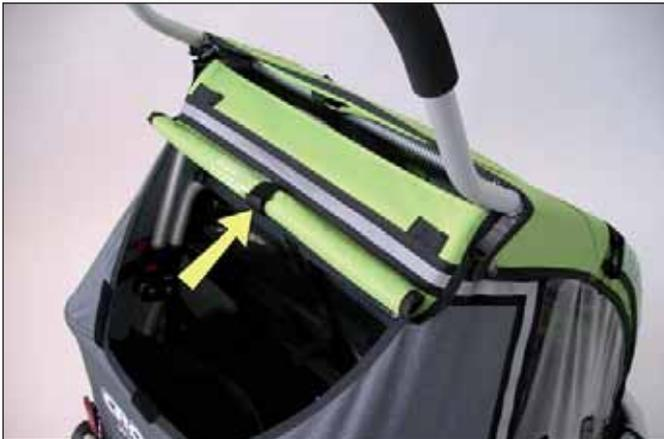
Für Reparatur- und Reinigungszwecke ist das 2 in 1-Verdeck auch komplett abnehmbar. Öffnen Sie dazu die seitlichen Druckknöpfe und das Spannband im Innenraum.
