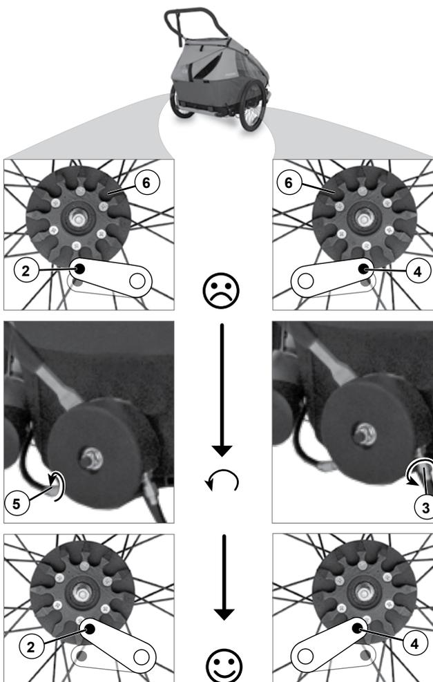
3. Greift der Bremszapfen (2) auf der linken Seite des Croozer nicht vollständig in die Rastscheibe (6), dann drehe die Einstellschraube (5) am Bremshebel so lange gegen den Uhrzeigersinn, bis der Bremszapfen (2) vollständig in die Rastscheibe (6) greift.
