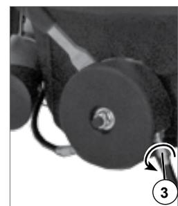
6. Montiere anschließend die Laufräder und prüfe die Funktion der Feststellbremse, indem du den Bremshebel nach hinten ziehst, und versuchst den Croozer voroder zurückzubewegen. Der Croozer darf sich nicht rollen lassen.
