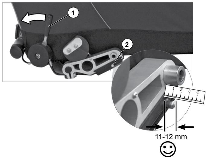
4. Ragt der Stift (4) auf der linken Seite des Croozer weniger als 11 mm aus dem Bremskörper heraus, dann drehe die Einstellschraube (5) am Bremshebel solange gegen den Uhrzeigersinn, so lange bis der Stift 11 bis 12 mm herausragt.
