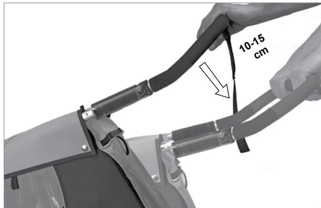
**Tipp:** Solltest du nicht sicher sein, ob der Croozer richtig beladen ist, kannst du diesen Test durchführen: Drücke den Schiebebügel des beladenen Croozer ohne Kind ca. 10–15 cm nach unten, so dass das Buggyrad vom Boden abhebt. Lasse den Schiebebügel los. Kehrt der Croozer sofort in die ursprüngliche Position zurück, ist er richtig beladen. Kehrt er nicht sofort in die ursprüngliche Position zurück, ist er überladen. So darfst du den Croozer auf keinen Fall benutzen.
