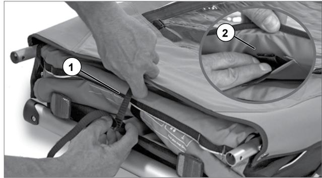
3. Halte den Rahmen des Croozer mit einer Hand fest und ziehe mit der anderen den Aufbau nach oben.
