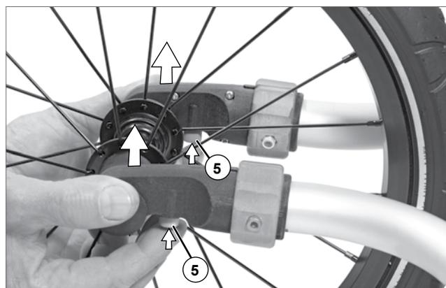
3. Zum Entfernen des Walker-Sets gehe in umgekehrter Reihenfolge vor. Drücke die Knöpfe (5) an beiden Ausfallenden und nehme das Walkerad nach unten heraus.
