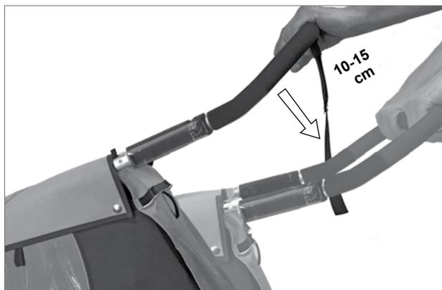
**Typ:** Solltest du nicht sicher sein, ob der Croozer richtig beladen ist, kannst du diesen Test durchführen: Drücke den Schiebepügel des beladenen Croozer ca. 10–15 cm nach unten, so dass das Walkerrad vom Boden abhebt. Lasse den Schiebepügel los. Kehrt der Croozer sofort in die ursprüngliche Position zurück, ist er richtig beladen. Kehrt er nicht sofort in die ursprüngliche Position zurück, ist er überladen. So darfst du den Croozer auf keinen Fall benutzen.
