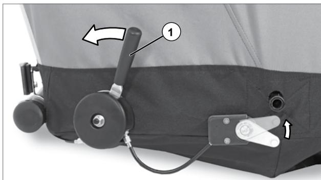
2. Sollten die Bremszapfen (2 und 4) auf einer oder auf beiden Seiten des Croozer nicht vollständig in die Rastscheiben (6) der Laufräder greifen, dann ist eine Justierung notwendig.
