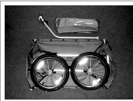
Rahmen mit Seitenteilen, 2 Laufräder, Deichsel mit Kupplung, Verdeck
